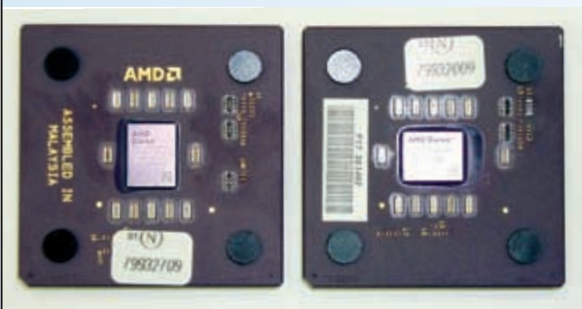
Слева на фото приведен процессор Duron с ядром Morgan, а справа – с ядром Spitfire.
